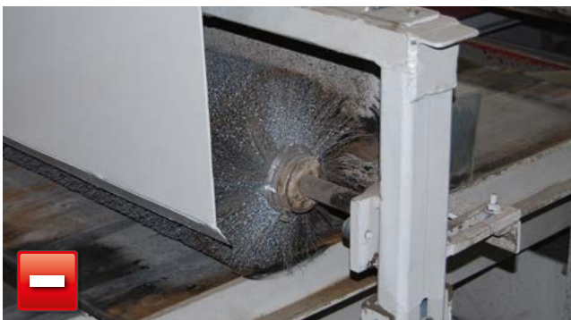
Konventionelle Reinigung mit Spiralkehrwalze
